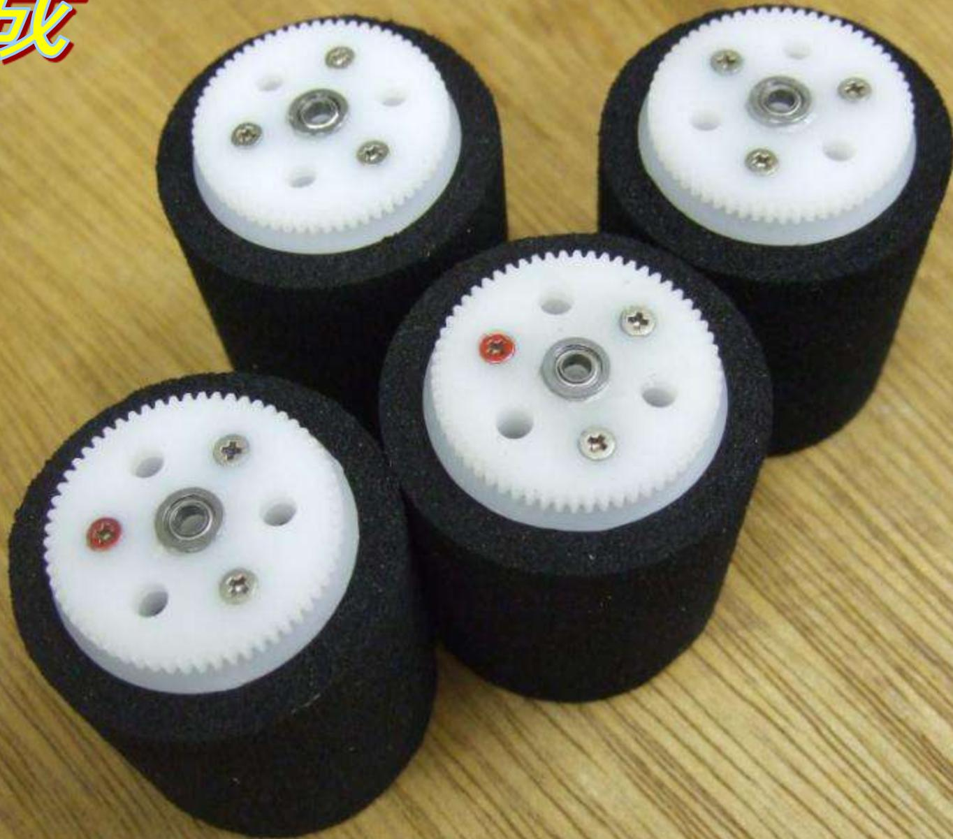
**重量のバランスが取れたタイヤ4個を必ず選択する**
