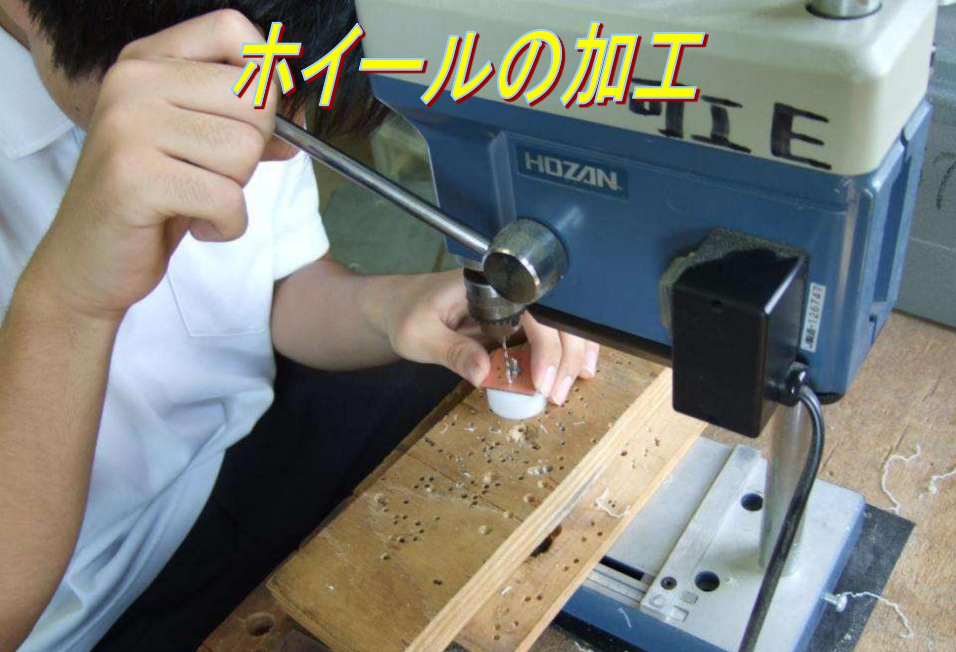
専用のジグを使って加工し軽量化
