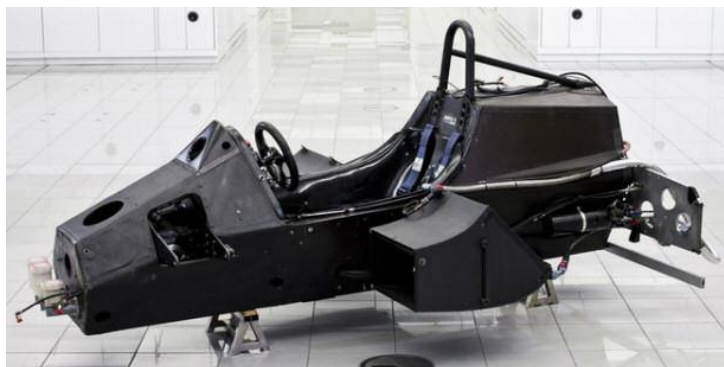
図表 4 レーシングカーに採用されるモノコックフレーム
